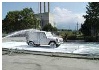
除染泡は、離れたところから適用することが可能である。(Allen Vanguard 社)
