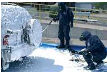
除染泡の車両への適用。泡は車両下のビニールの小段（berm）で集められる。 (Allen Vanguard社)
