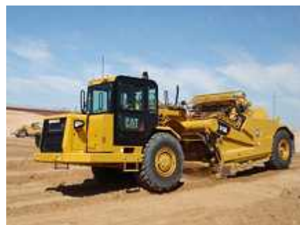
エレベーターティンク・スクレイパー (Elevating Scraper) ~ $175/hr (約14000円/時) 容量 26 m 3
