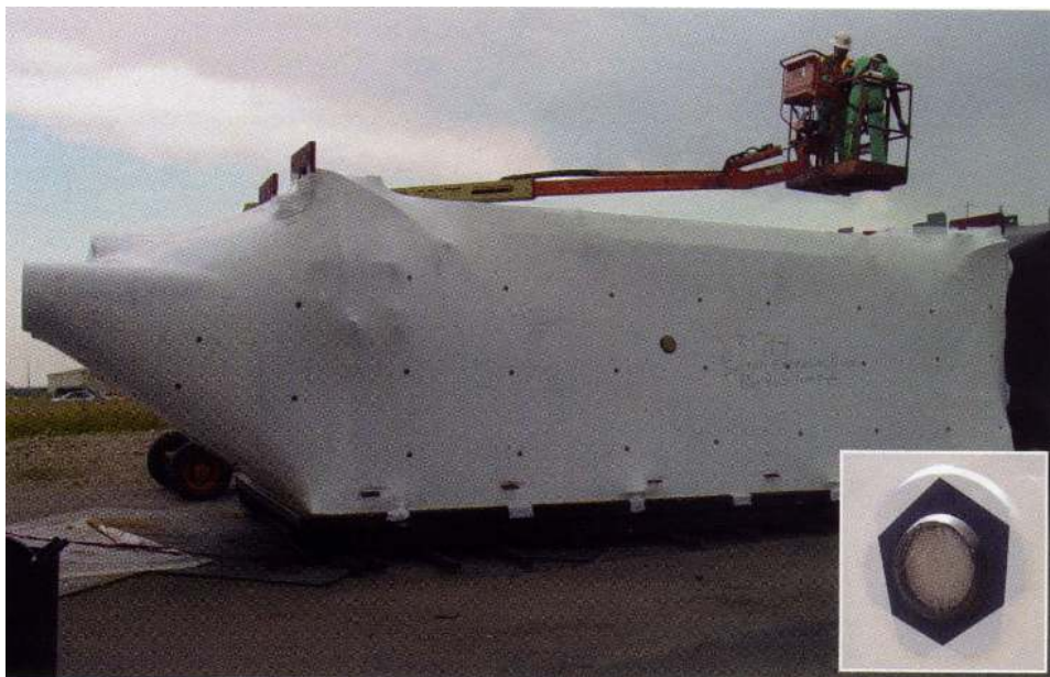
収縮ラップした押出プレス機にリフト用プレートと膜圧計測プレートを取り付けた状態。 右下写真：側面の HEPA フィルター
