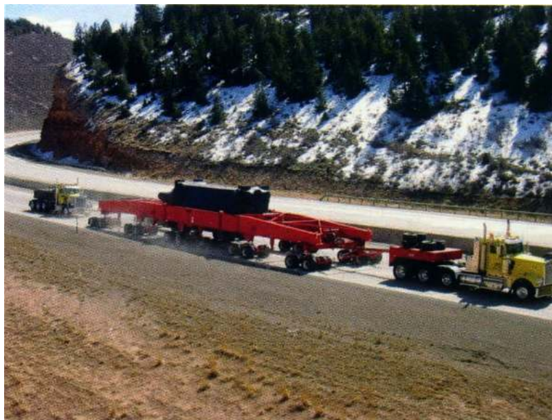
重さ 130t の押出プレス機 (Sutton) をコロラド州ロッキーフラッツからユタ州の Envirocare 社の低レベル廃棄施設まで輸送
