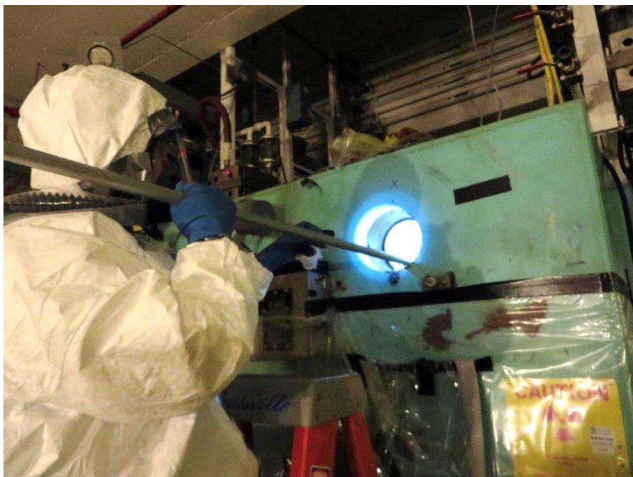
作業員が棒の先端に取り付けたこすり取りパッドでサンプルを採取している
